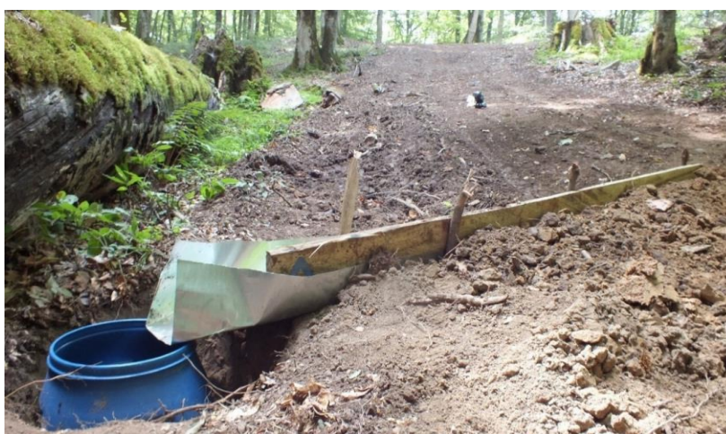
شکل ۱- نحوه استقرار مخزن ۱۵۰ لیتری در پایین قطعه نمونه برای جمع‌آوری رواناب
