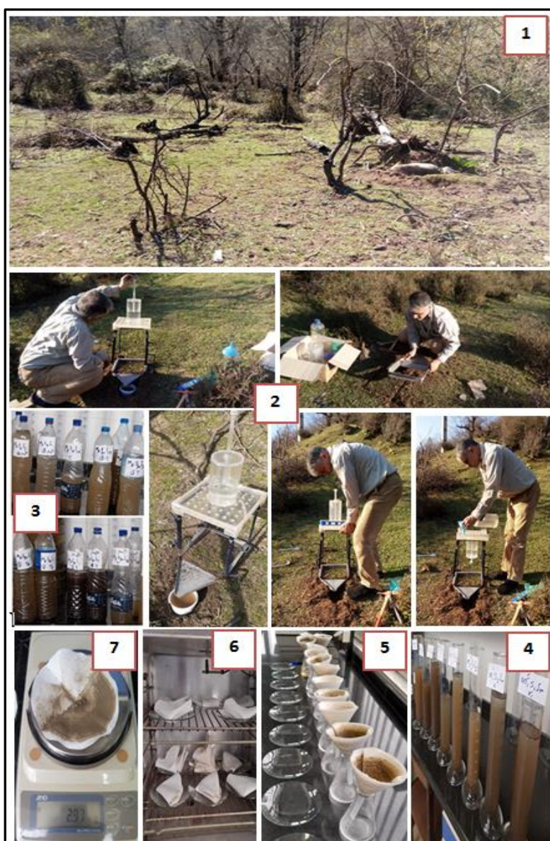
شکل ۳- روند اجرای پژوهش: منطقه جنگلی سوخته (۱)؛ نحوه استقرار پلات‌ها با شبیه‌ساز باران و نمونه‌برداری رواناب و رسوب (۲)؛ جمع‌آوری رواناب و رسوب (۳)؛ اندازه‌گیری رواناب در آزمایشگاه (۴)؛ جداسازی رسوب (۵)؛ خشک کردن و توزین رسوب (۶ و ۷)
