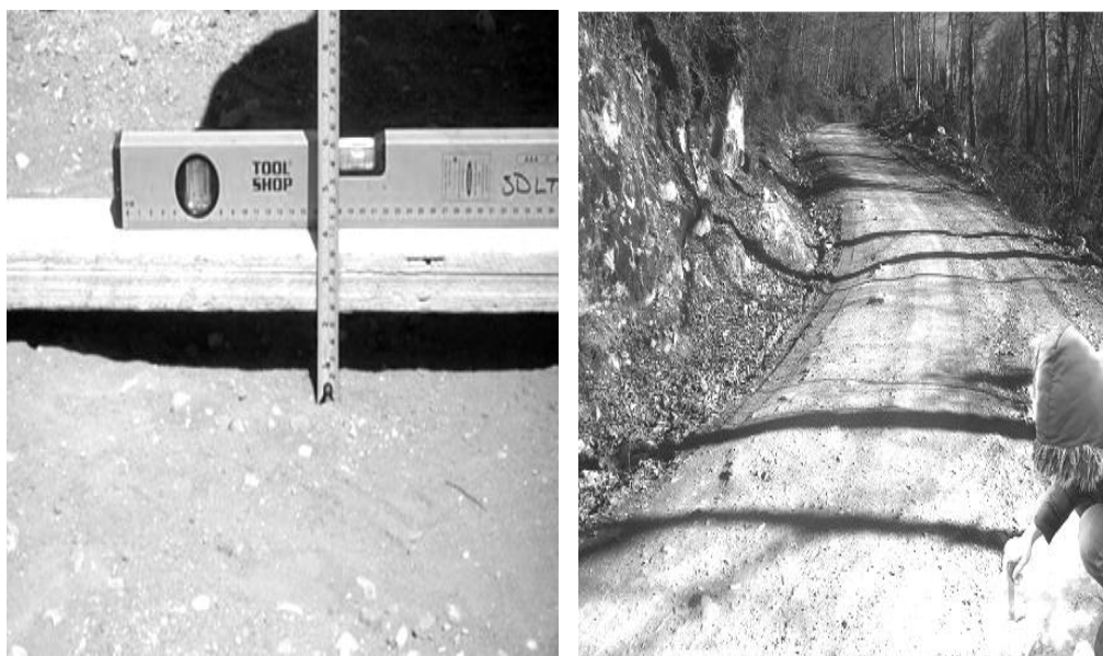
شکل ۱- نحوه اندازه‌گیری خرابی‌های جاده‌های جنگلی
