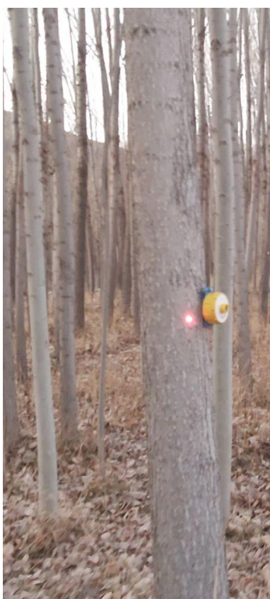
شکل ۳- برخورد نور لیزر دستگاه لایکا به تنه صنوبر برای اندازه‌گیری قطر Figure 3. Laser beam from a Leica device hitting a poplar stem to measure the diameter
