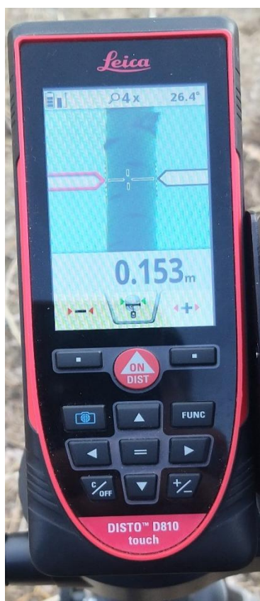
شکل ۴- محاسبه قطر در ارتفاع بالاتر از برابر سینه تنه درخت صنوبر Figure 4. Calculating the diameter at height above breast height of a poplar tree stem
